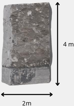
Nos structures sont étudiées et calculées par un bureau d'études se basant sur un scan 3D des blocs et des données techniques de la roche utilisée. Ces éléments sont ensuite validés par un bureau de contrôle
